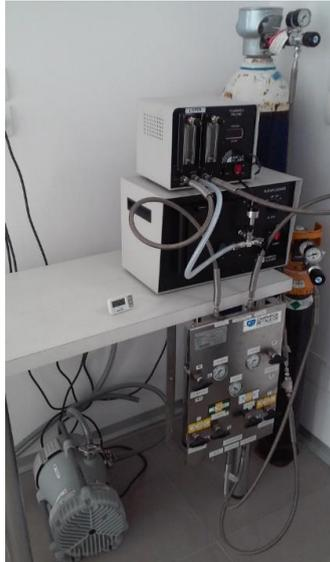
**Fig 4.5** Equipo Harrick Plasma Cleaner PDC-002 sobre la mesa, a la derecha las bombonas de oxígeno y argón y a la izquierda el compresor
