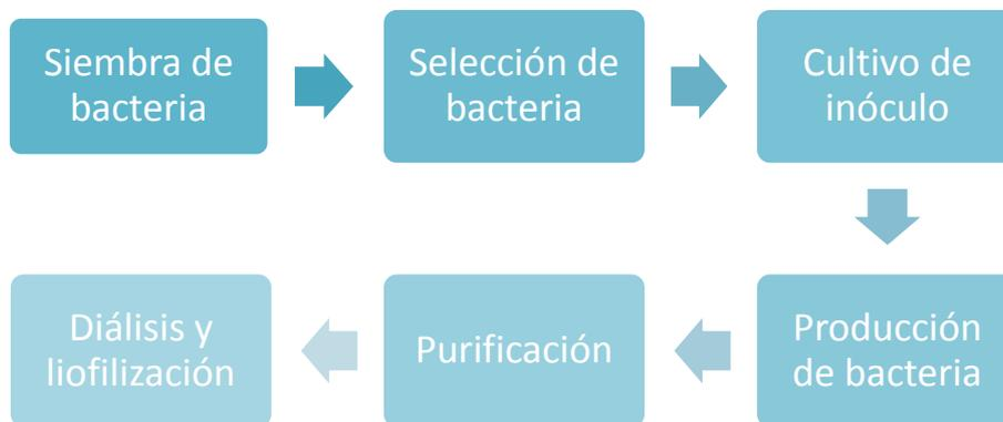
**Figura 4.8** Esquema del proceso de bioproducción y purificación de polímero
