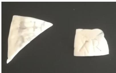
**Fig 5.24** Cambio de aspecto con tratamiento de metanol y agua mQ: a la izquierda se observa la membrana 2 y a la derecha la membrana 1
