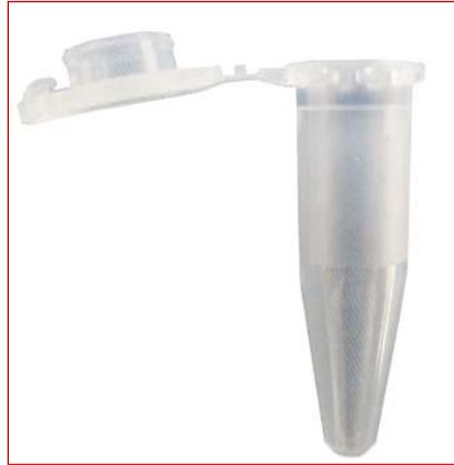
Figura 6. Tubo de centrífuga Eppendorf Safe-Lock de 1'5 mL.
