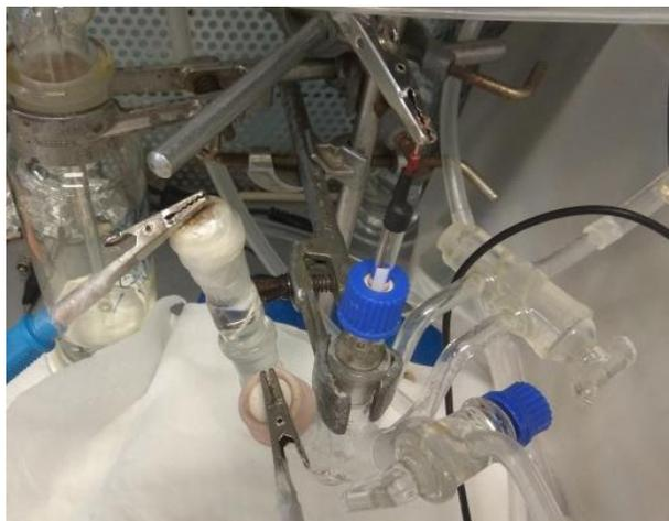
*Figura 11. Celda electroquímica utilizada en la voltamperometría cíclica.*
