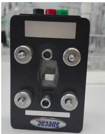
Figura 8. Celda espectroelectroquímica.
