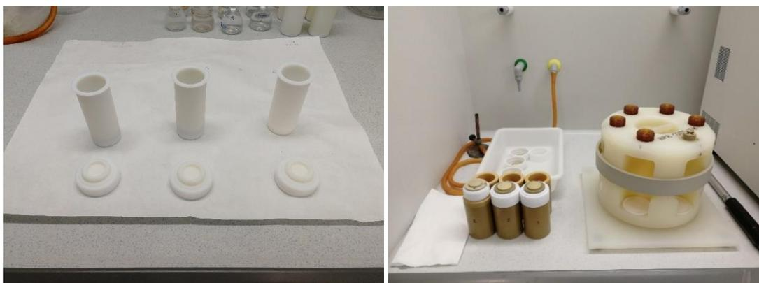
**Imagen 1.** Recipientes de PTFE (izda.) y camisas y soporte rotatorio (drcha.) para la digestión en horno de microondas
