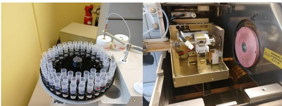
**Imagen 4.** Automuestreador (izda.), antorcha e interfase (drcha.)
