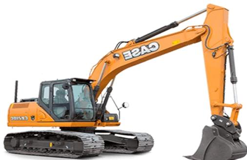
Figura 1. Retroexcavadora
