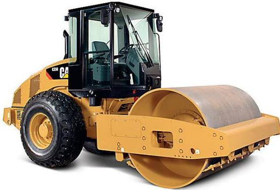
Figura 7. Rodillo compactadora
