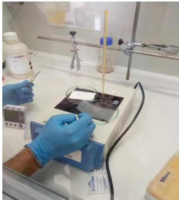
Figura 9.b Distribución del procedimiento seguido para 37°C, donde se observa el calentador con la placa y el Parafilm (con las gotas), y la otra placa en la que dejamos secar la muestra
