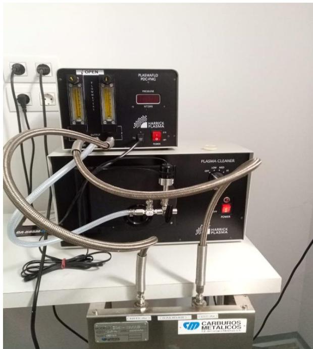
Figura 9.a Plasma cleaner (en medio), controlador de presión (encima) y bomba de vacío (debajo de la mesa)
