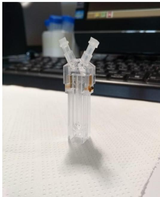
Figura 13 Cubeta zeta utilizada, en la que se observan los electrodos
