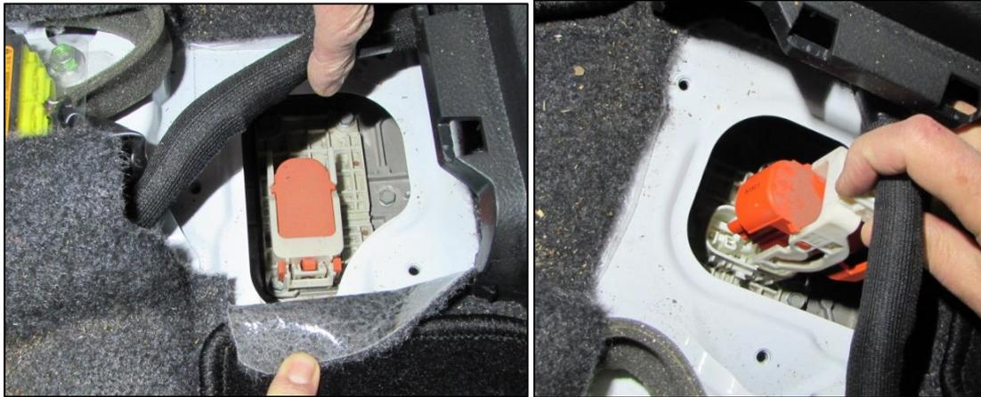
Figura 7.15: Retirada del conector de servicio.
