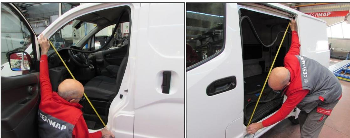
Figura 7.9: Izq: medición hueco puerta conductor. Der: medición hueco portón lateral de carga. Fuente: Elaboración propia.
