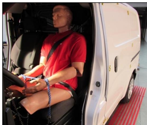
Figura 7.23: *Dummy* de 75 kg de peso. Fuente: Elaboración propia.
