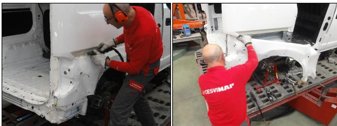
Figura 7.41: Sección parcial en el panel lateral trasero.
