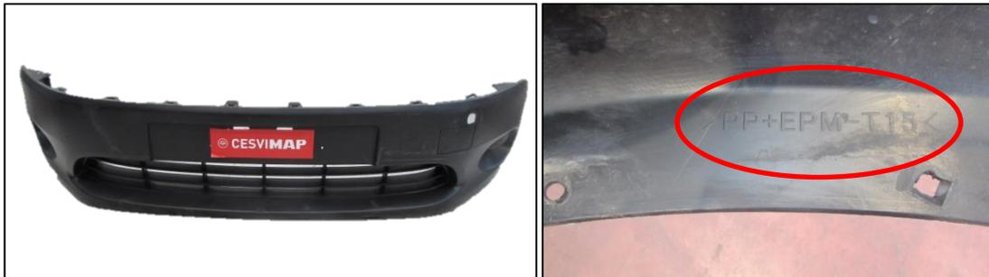
Figura 7.2: Paragolpes delantero Nissan e-NV200. Material: Polipropileno + Etileno-Propileno-Monómero con carga reforzante de Talco (T) un 15%.
