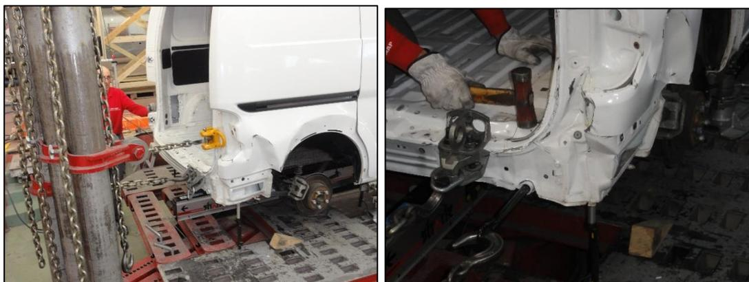
Figura 7.40: Estiraje mediante bancada para restablecer cotas de diseño.
