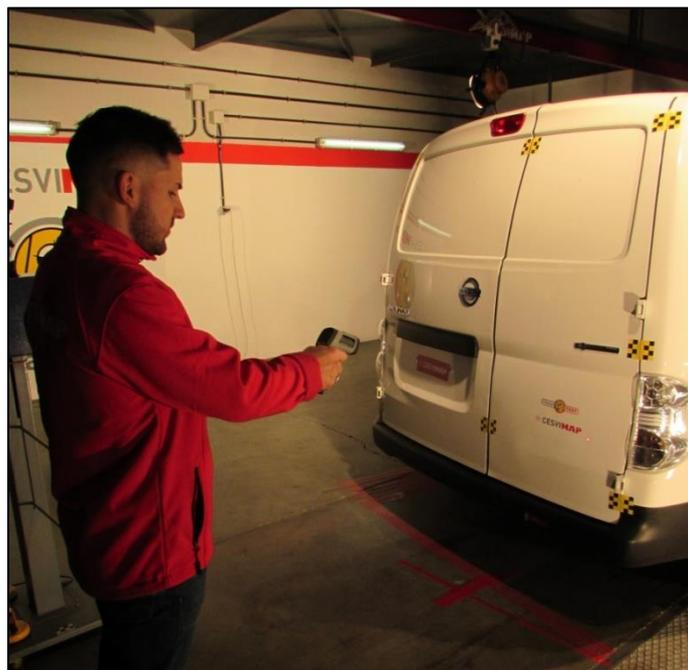
Figura 7.30: Medición de la temperatura de diferentes elementos de la carrocería exterior. Fuente: Elaboración propia.
