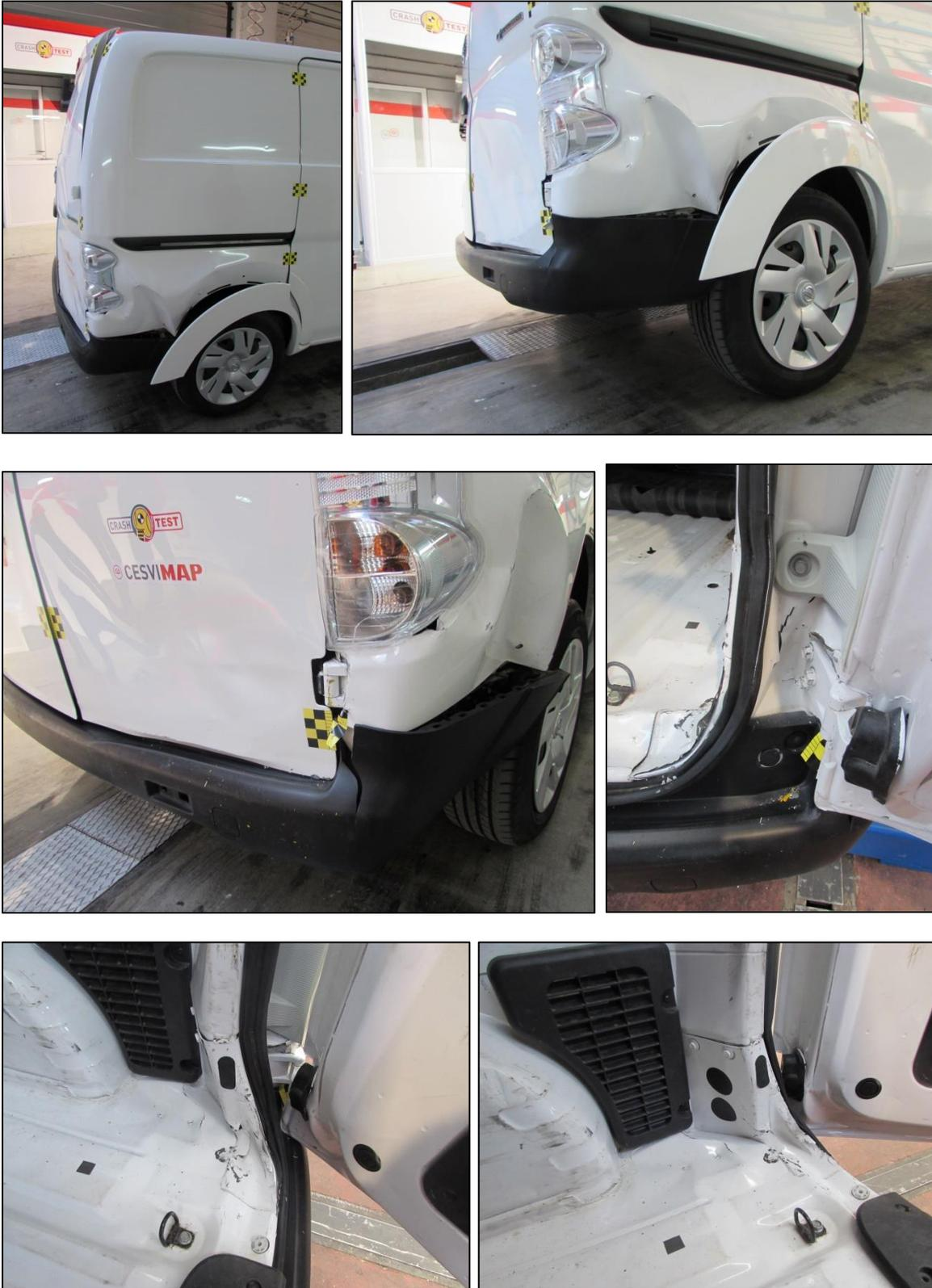
Figura 7.32: Resultado Crash Test trasero y medición de las holguras tras golpe.
