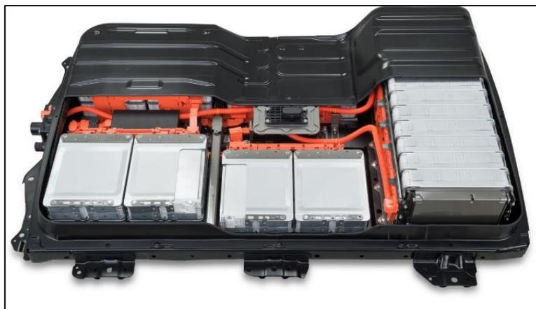
Figura 3.5: Organización de las celdas de una batería de vehículo eléctrico Nissan Leaf.
