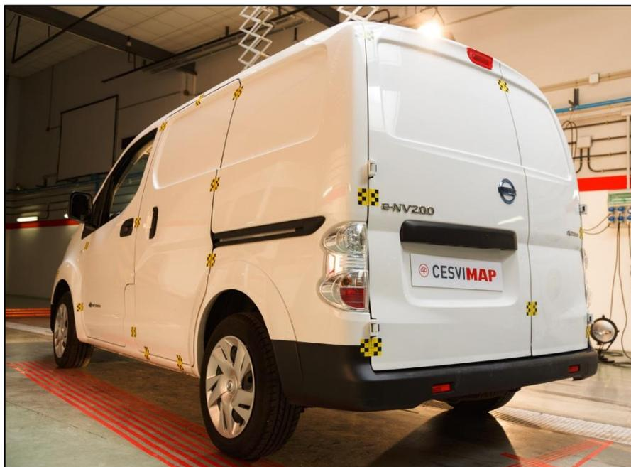
Figura 7.21: Colocación de adhesivos métricos.
