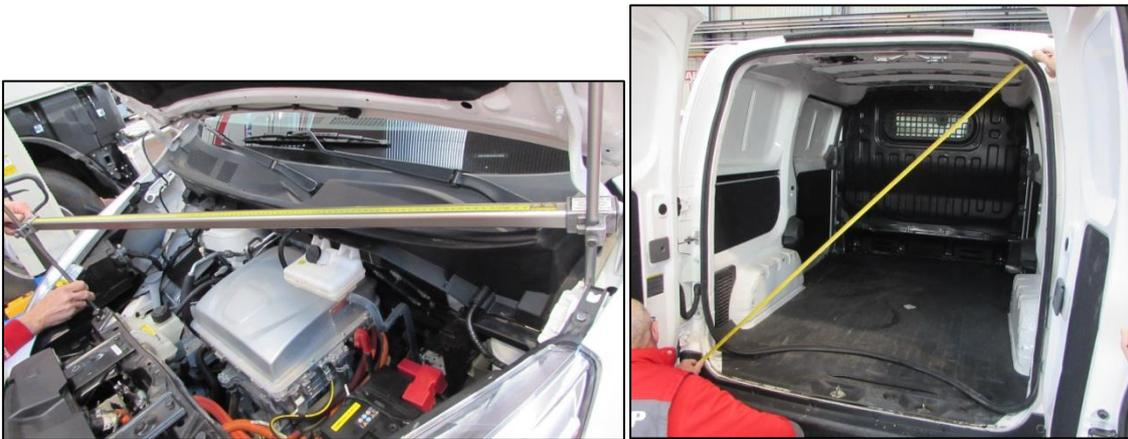
Figura 7.8: Izq: medición hueco del motor con compas de varas. Der: medición hueco portón trasero. Fuente: Elaboración propia.
