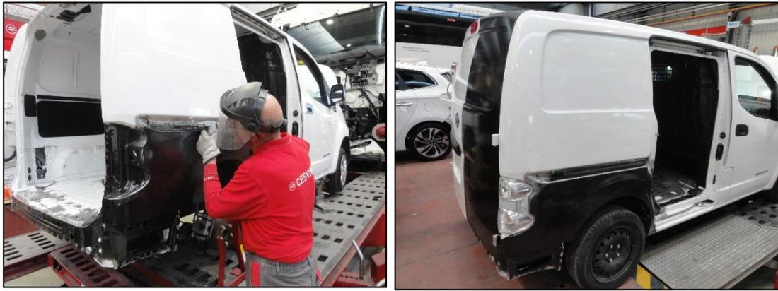
Figura 7.43: Presentación del recambio, soldadura y resultado de la reparación.
