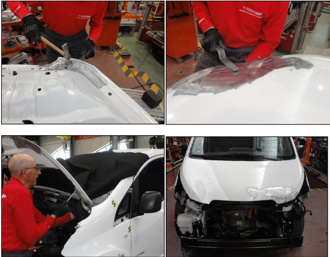
Figura 7.71: Reparación del capó y sustitución de las bisagras.
