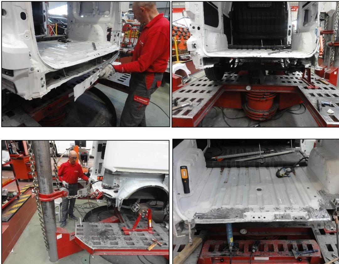
Figura 7.42: Corte del faldón trasero y estiraje en bancada.
