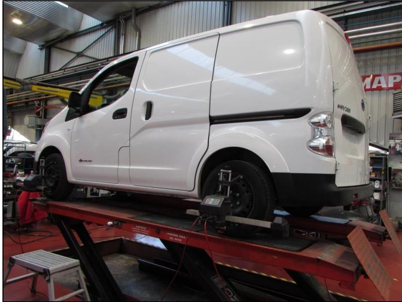
Figura 7.17: Alineación de las ruedas en bancada.
