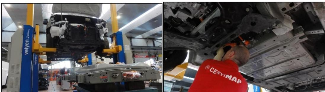
Figura 7.74: Montaje de la batería de alta tensión en la Nissan e-NV200.
