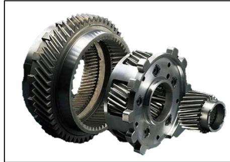
Figura 4.4: Engranaje planetario Toyota Prius.
