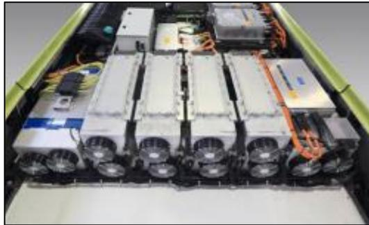
Figura 3.20: Supercondensadores empleados en el bus MAN Lion'S City Hybrid.
