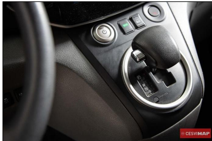
Figura 7.82: Palanca de cambios Nissan e-NV200.
