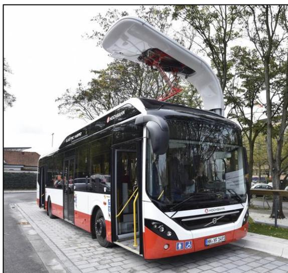
Figura 6.7: Recarga de bus eléctrico mediante pantógrafo.
