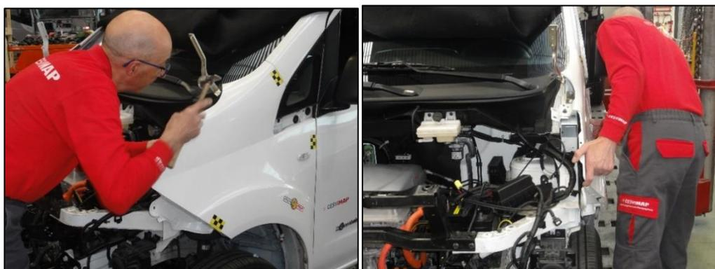
Figura 7.70: Reparación de la aleta izquierda.
