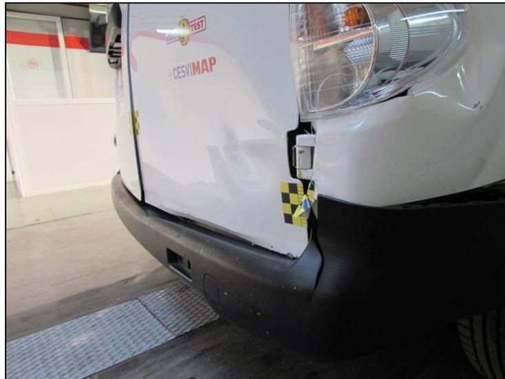
Figura 7.36: Daños en portón, paragolpes, bisagra, piloto y panel lateral.
