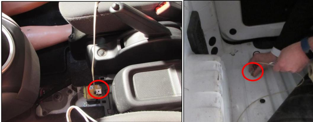
Figura 7.24: Fijación de los acelerómetros a estructura rígida del vehículo.
