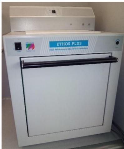
**Figura 9.- Horno microondas ETHOS PLUS MILESTONE**
