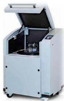
**Figura 8.- Molino de discos vibratorios RETSCH**
