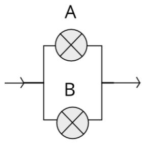
**Ilustración 18. Circuito eléctrico de 2 lámparas en paralelo**
