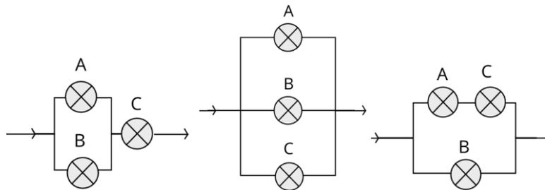
**Ilustración 19. Distintos circuitos eléctricos con lámparas en serie y paralelo.**
