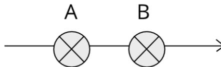
Ilustración 17. Circuito de dos lámparas en serie
