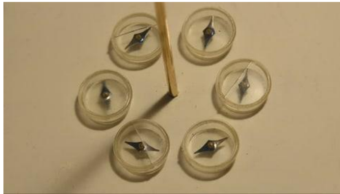
Figura 4-21. Campo producido por un conductor rectilíneo a través de brújulas. Recuperado de: https://www.shutterstock.com/es/video/search/experimento-de-oersted
