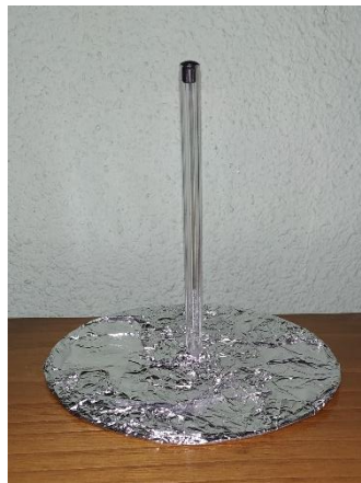
Figura 4-4. Electr6foro casero construido para la realizaci6n de experimentos.
