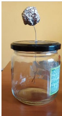
Figura 4-5. Electroscopio fabricado para el desarrollo de nuestros experimentos
