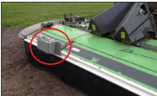
Figura 66: Pasture reader acoplado a una segadora. Fuente: Hendriks *et al.*, 2017
