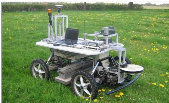
Figura 68: Pasture robot. Fuente: Gobor et al., 2015.
