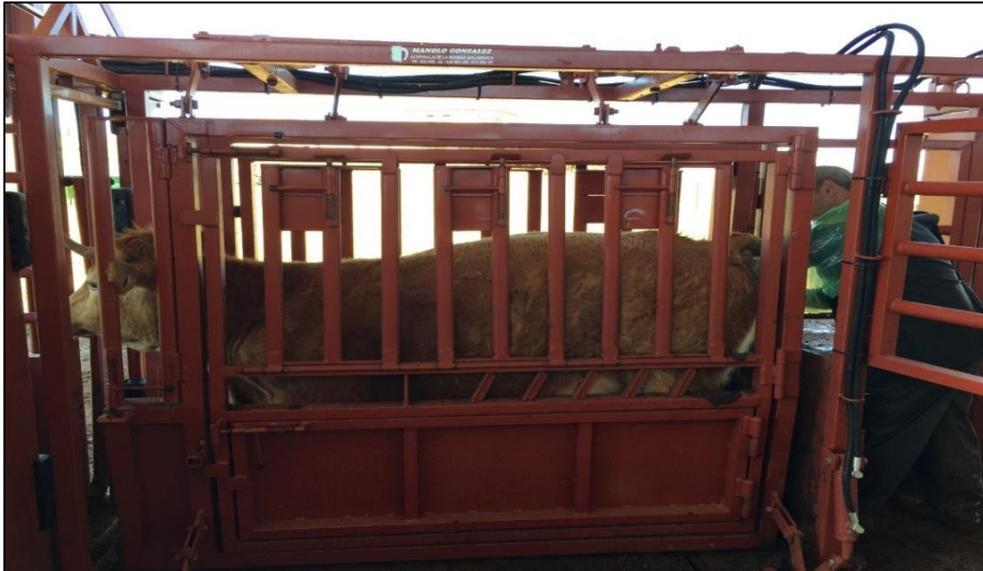
Figura 74: Manga de manejo hidráulica. Fuente: Proyecto CIVEX.
