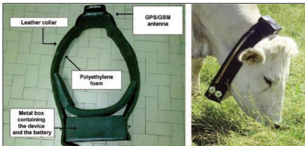
Figura 61: Dispositivo GPS. Fuente: Tangorra *et al.*, 2013.
