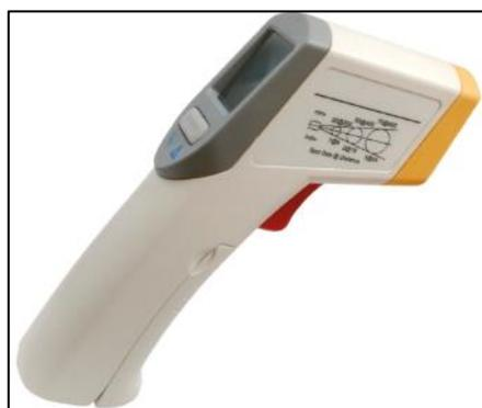
Figura 26: Termómetro infrarrojos. Fuente: Humeco
