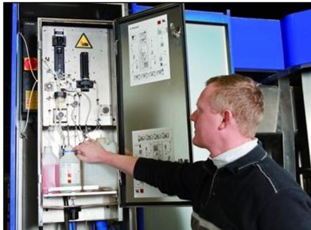
Figura 22: Contador de células online OCC. Fuente: DeLaval
