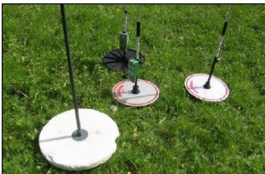
Figura 65: Altímetro para la medición del pasto. Fuente: Hendriks *et al.*, 2017
