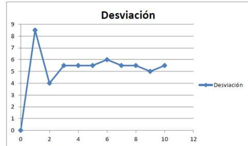
Figura 9. Resultado de la desviación final de la trayectoria cuadrada de  $200 \times 200$  mm para 10 repeticiones.
