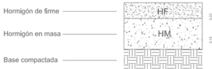
Figura 28. Espesor plataformas auxiliares
