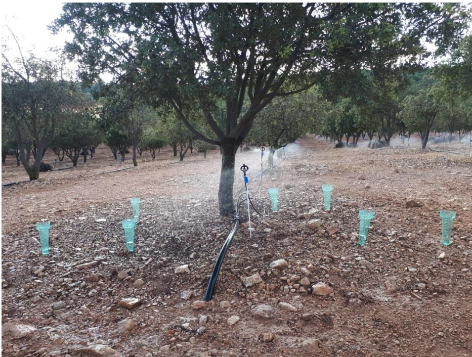
Figura 4: Imagen de un difusor en activo y pluviómetros repartidos sobre la superficie regada. Fuente: Elaboración propia.
