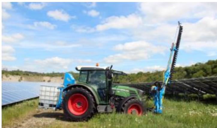
Figura nº 3. Limpieza de módulos con vehículo + brazo
