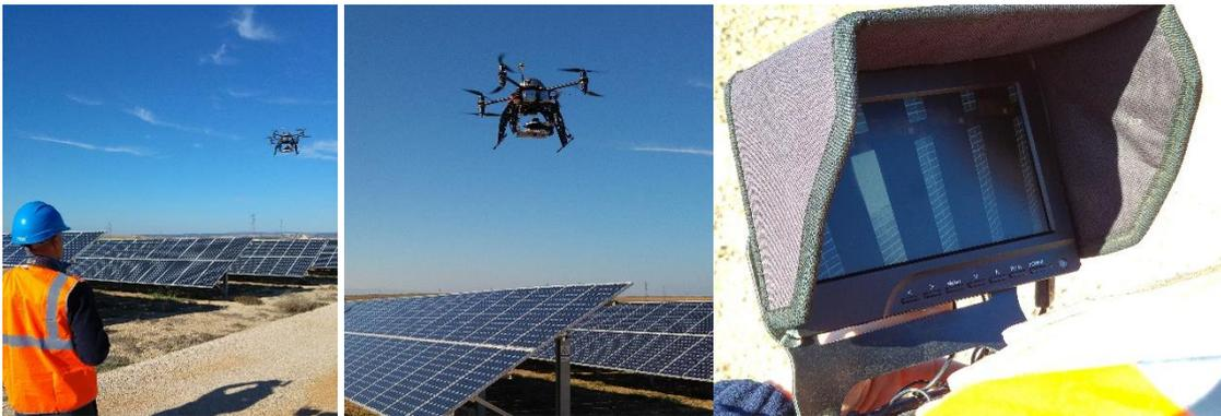
Figura n° 4. Inspección termográfica con dron
