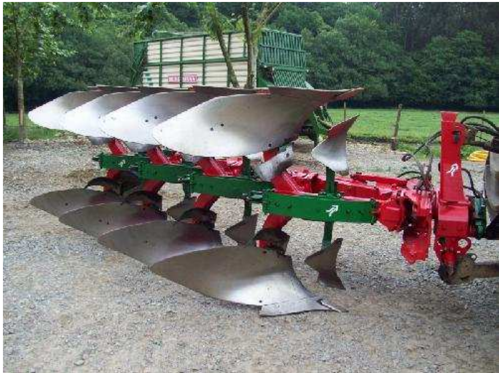
Ilustración 2. Arado de vertedera Kverneland
