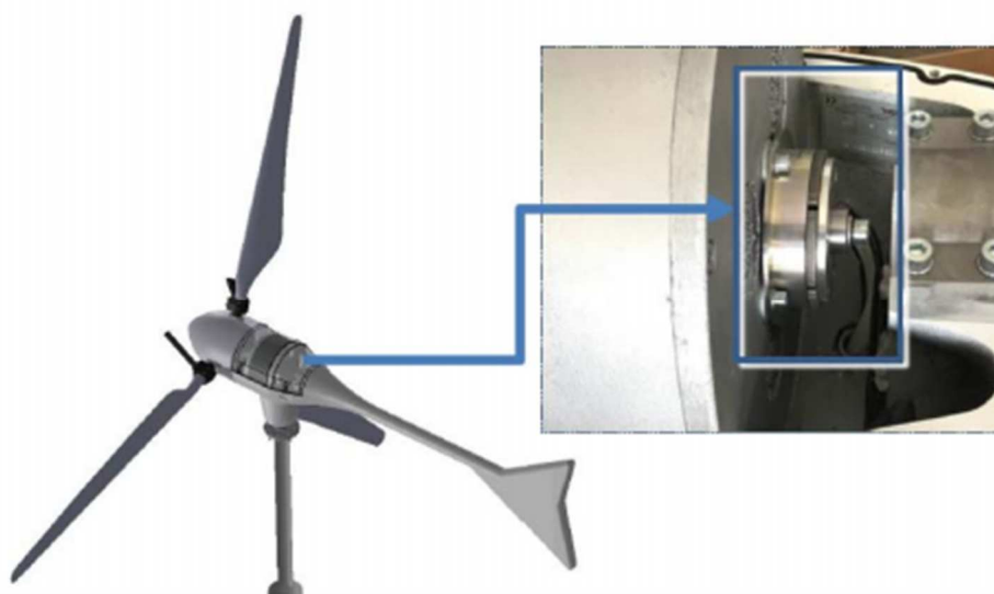
Ilustración 5. Aspecto visual del sistema de freno mecánico para huracanes y tormentas.
