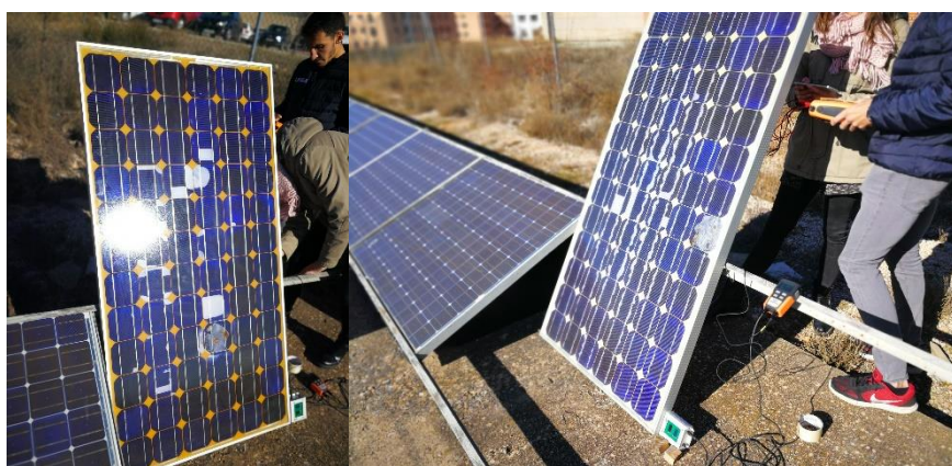
Imagen nº 33: disposición de los paneles fotovoltaicos para la toma de medidas de sus curvas I-V. Fuente: Elaboración propia.
