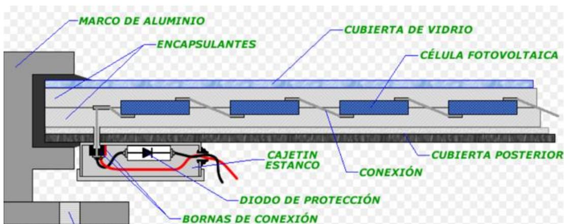
Imagen nº 5: principales elementos de un panel fotovoltaico. Fuente: [5]
