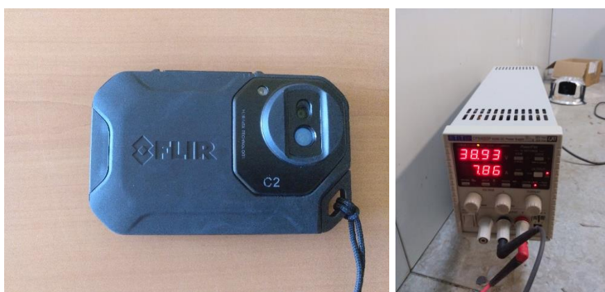
Imagen nº 37: cámara termográfica y fuente de alimentación utilizada en la EL. Fuente: Elaboración propia.
