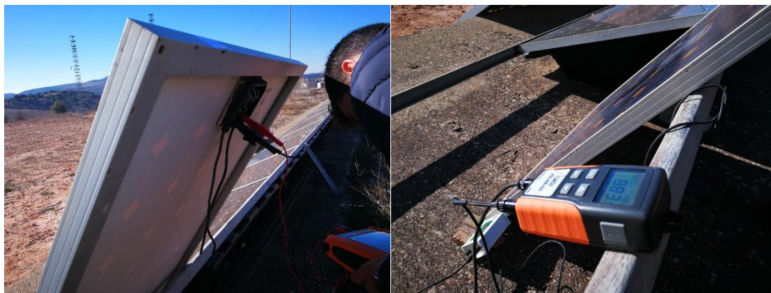
Imagen nº 35: toma de medidas con el trazador SOLAR I-Ve y del SOLAR 02. Fuente: Elaboración propia.
