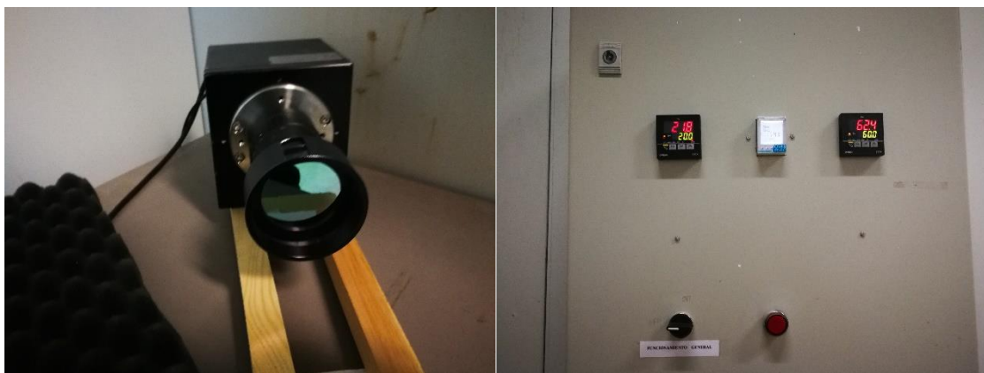
Imagen nº 30: colocación de la cámara con la que se toman las medidas de electroluminiscencia y parámetros de humedad y temperatura de la cámara de secado. Fuente: Elaboración propia.
