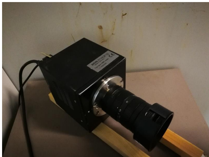
Imagen nº 21: cámara (pco.1300) utilizada para las mediciones de EL. Fuente: Elaboración propia.
