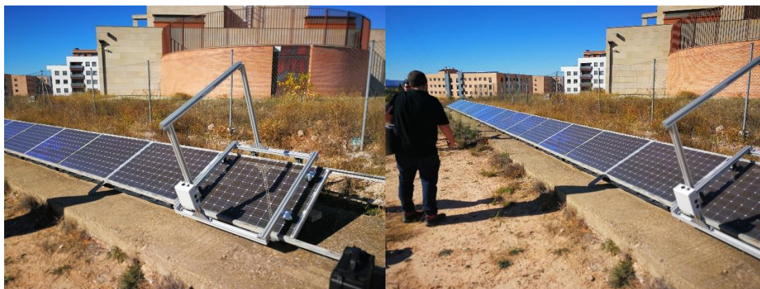
Imagen nº 26: plataforma medición electroluminiscencia y módulos fotovoltaicos del Campus Duques de Soria. Fuente: Elaboración propia.
