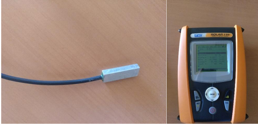
Imagen nº 38: sensor de temperatura utilizado para la medición de las curvas I-V y ejemplo de datos medidos de cada panel al trazador SOLAR I-Ve. Fuente: Elaboración propia.
