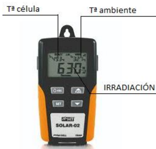
Imagen nº 19: SOLAR 02. Fuente: Elaboración propia.
