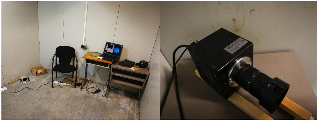
Imagen nº 29: interior de la cámara de secado e imagen de la cámara especializada para los ensayos de EL (pco.1300 solar). Fuente: Elaboración propia.
