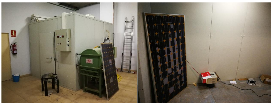
Imagen nº 28: cámara de secado donde se realizan las pruebas de electroluminiscencia. Fuente: Elaboración propia.
