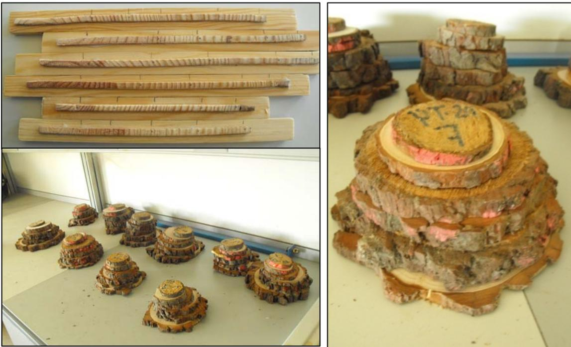
**Foto 2. Procesamiento de muestras.-** secado, montaje sobre soportes de madera, prensado, lijado
