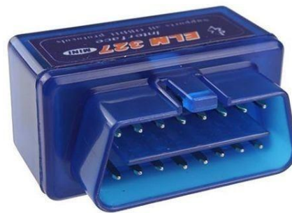
Figura 5: Escáner OBD ELM327
