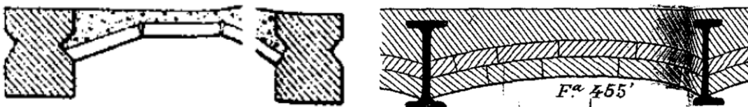
Figura 4 (izq.): Forjados con viguetas de madera y entrevigado cerámico. Fuente: Ger y Lobez, 1898,
