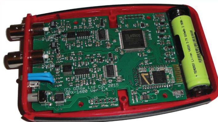
Figura 17. Hardware del OscBox-1600
