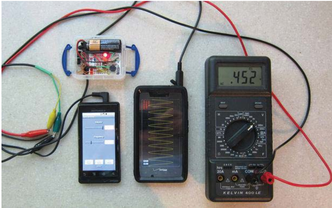
Figura 12. Oscilloscope Pro midiendo a través de la entrada de audio
