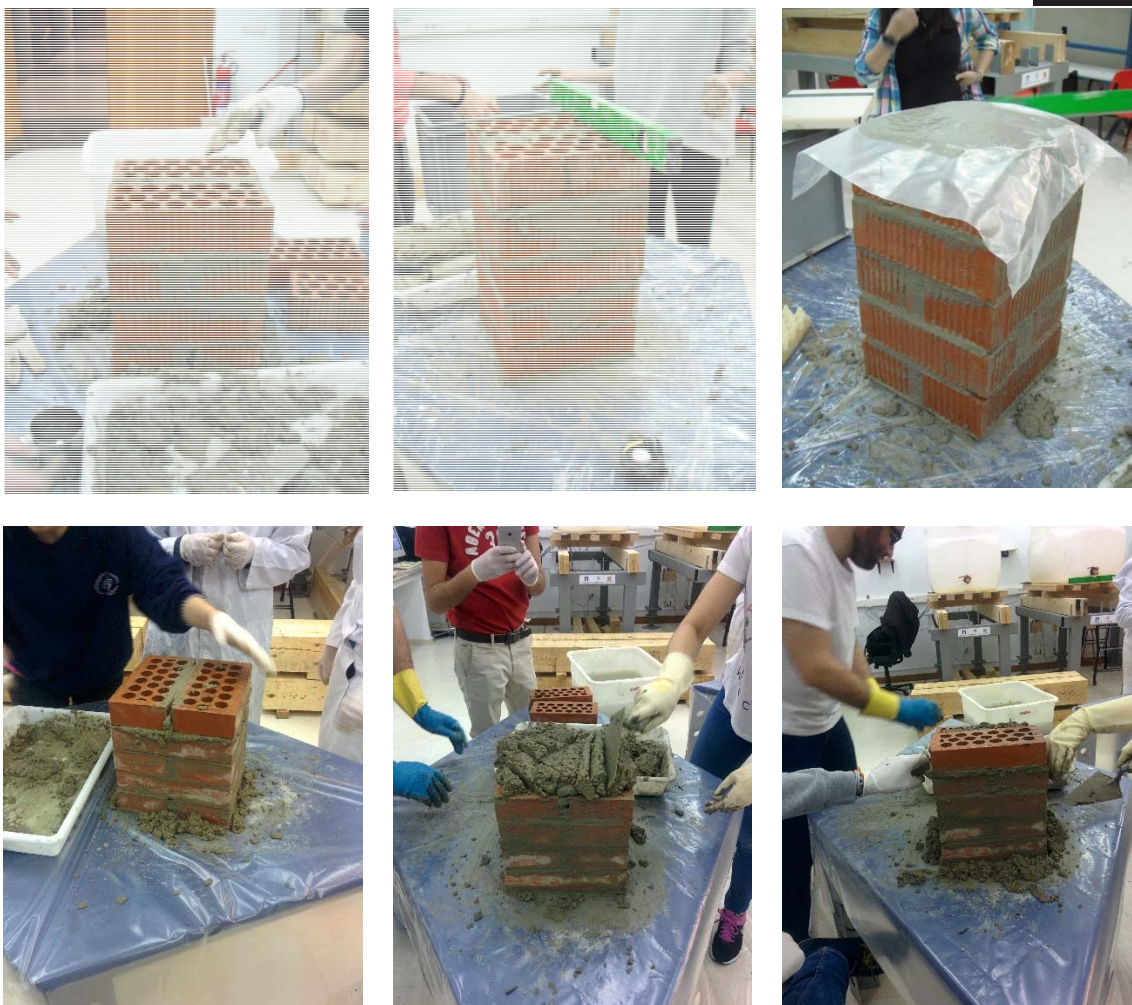
Fig. 11. Ejecución de las probetas de fábrica realizadas por los propios alumnos.
