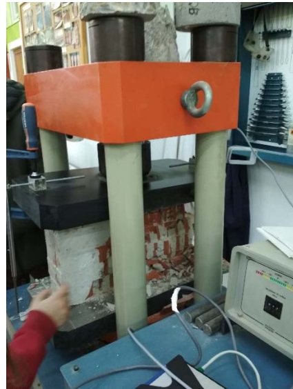
B) Rotura de probeta tras ensayo.
