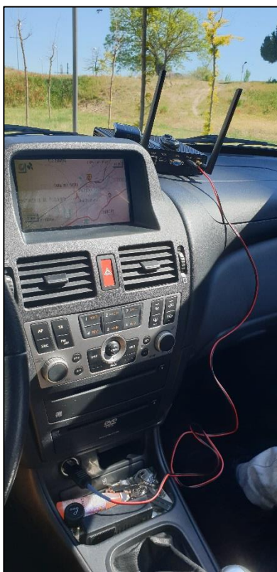
Figura 91. Instalación del miniordenador en el salpicadero del vehículo A
