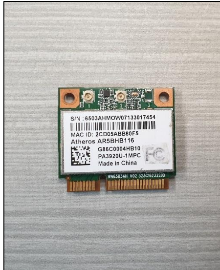
Figura 44. Tarjeta de red Atheros ATH9K AR5BHB116
