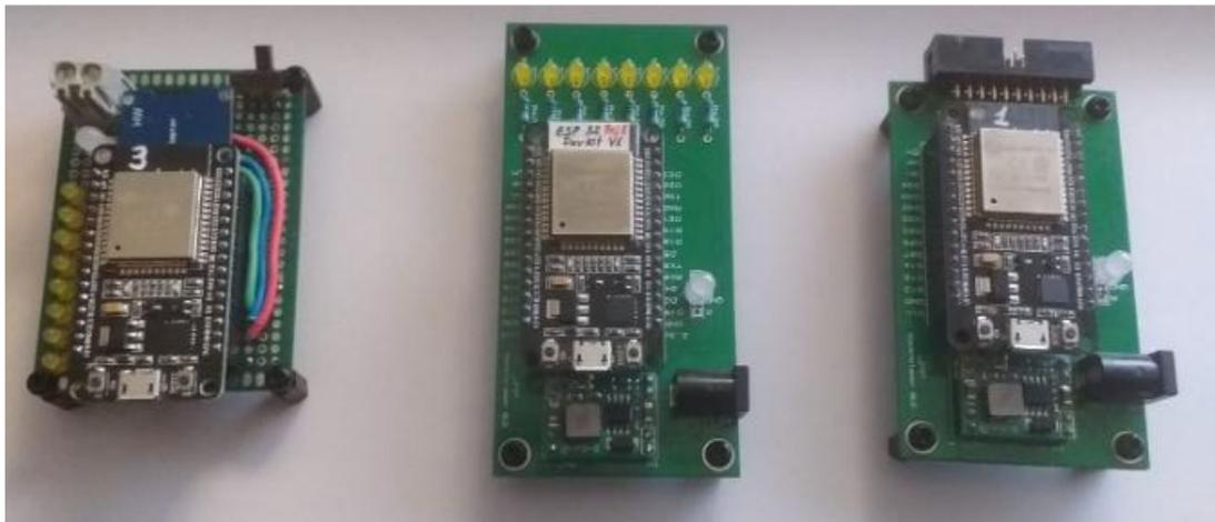
*Ilustración 39: Izq-Drch: Prototipo Inicial, Placa Testeo, Placa Final*
