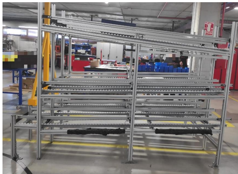
Fig.53. Prototipo final de rack estático
