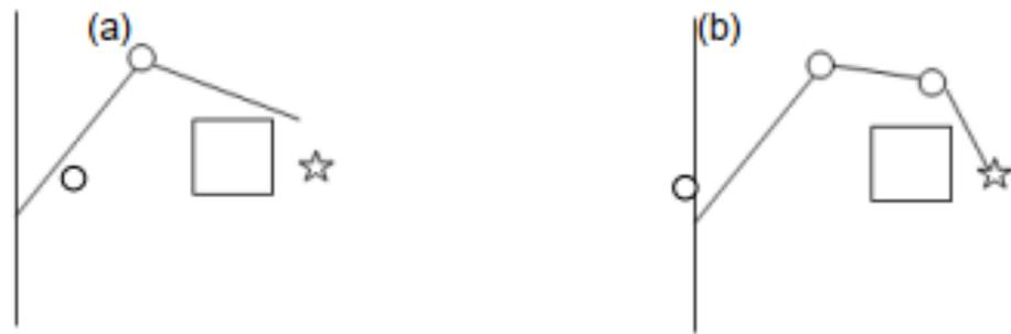
Figura 1: a) No redundante. b) Redundante [Martín, 2017].
