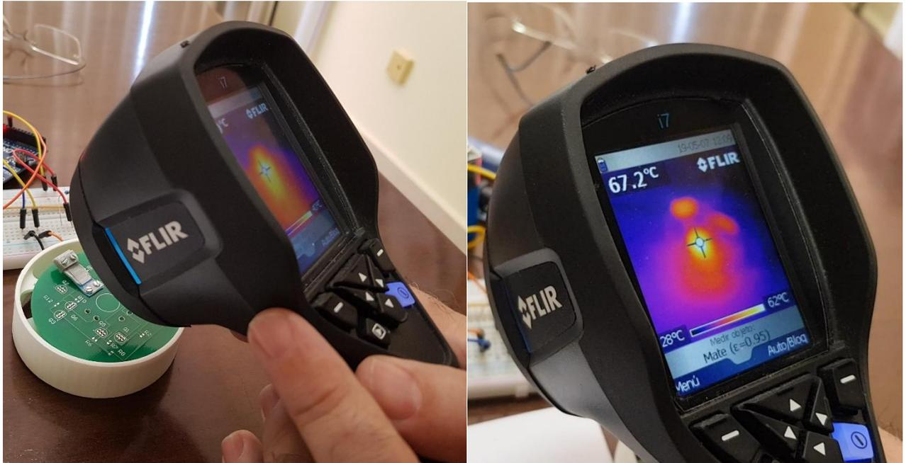
Figura 43: Temperatura alcanzada por el Nitinol
