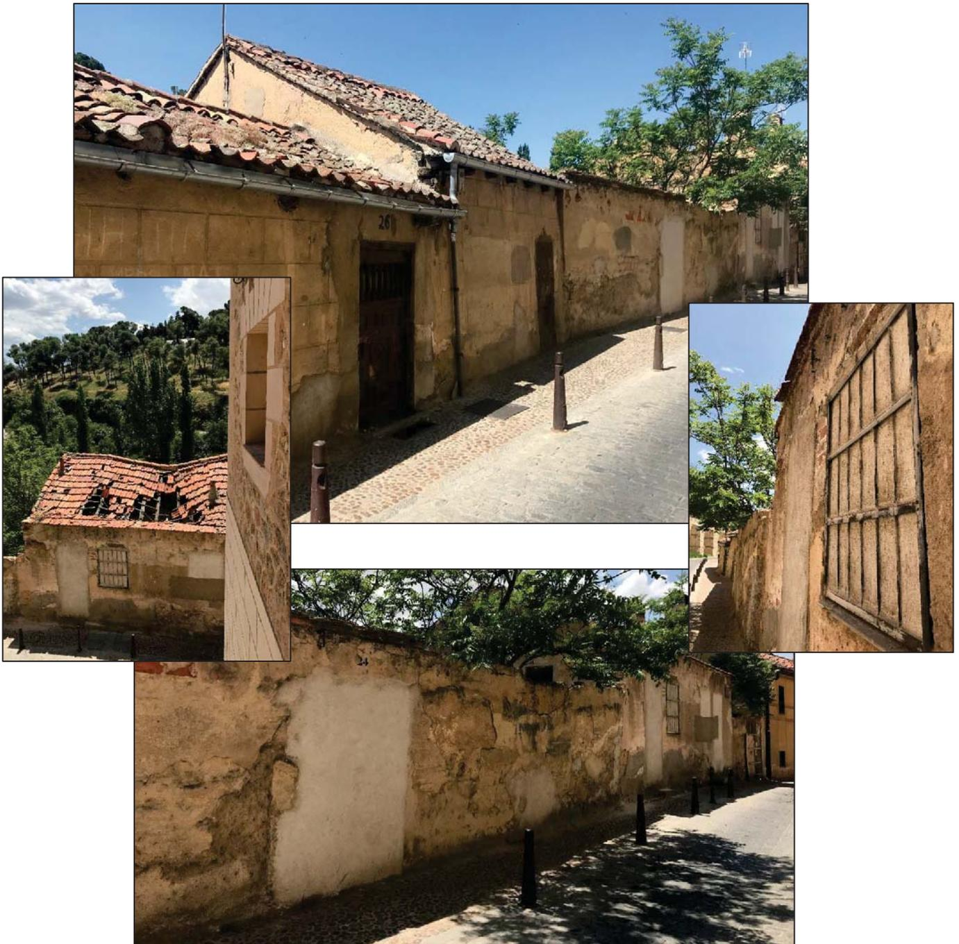
Ilustraciones 30, 31, 32 y 33. Inmuebles nº 22, 24 y 26 de la calle San Valentín. El mayor ejemplo de abandono y deterioro de inmuebles en el barrio de la Judería. Fachadas y cubiertas destruidas (ruina total), ventanas y puertas tapiadas, sin instalaciones ni saneamiento etc.
