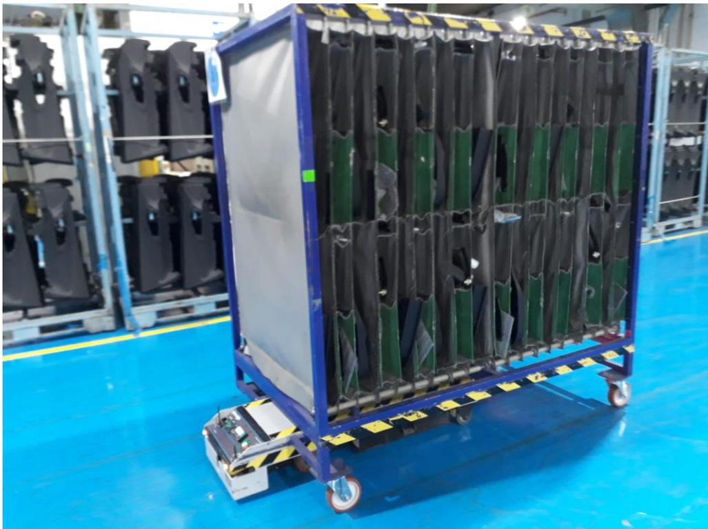
Imagen 7.1. AGV transportando un contenedor.
