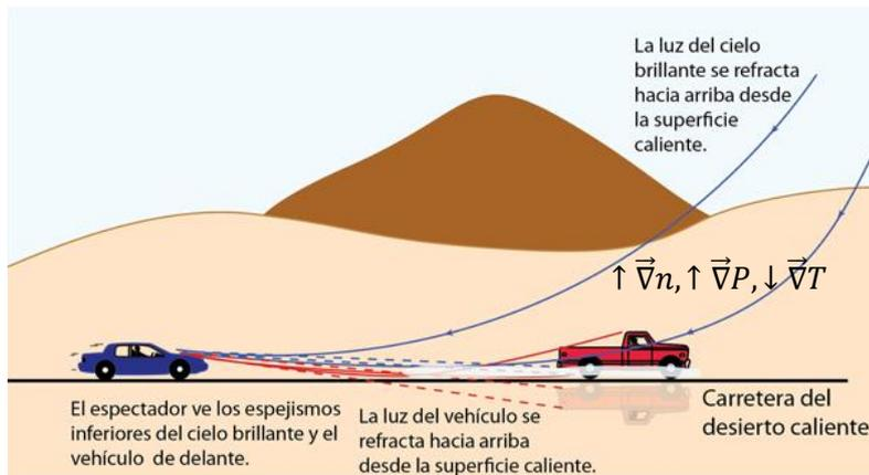
Figura 60. Explicación de un espejismo inferior común en carreteras del desierto.
