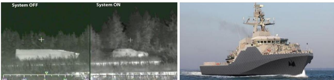
Figura 36. El camuflaje Adaptiv permite hacer invisible un tanque o cualquier vehículo militar, enmascarando su firma infrarroja, inutilizando los sistemas hostiles de imágenes térmicas. Adaptiv es capaz de proteger grandes piezas de equipo militar contra la detección al permitir que los vehículos imiten la temperatura de sus alrededores para adaptarse a diferentes terrenos. También puede hacer que un tanque se parezca a otros objetos, como una vaca o un automóvil, o arbustos y rocas [75].
