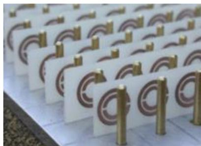
Figura 8. Primer metamaterial propuesto por Smith et al. basado en una estructura periódica de SRRs y alambres metálicos [106].
