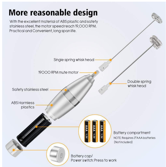
Figura 51. Mecanismo batidor eléctrico
