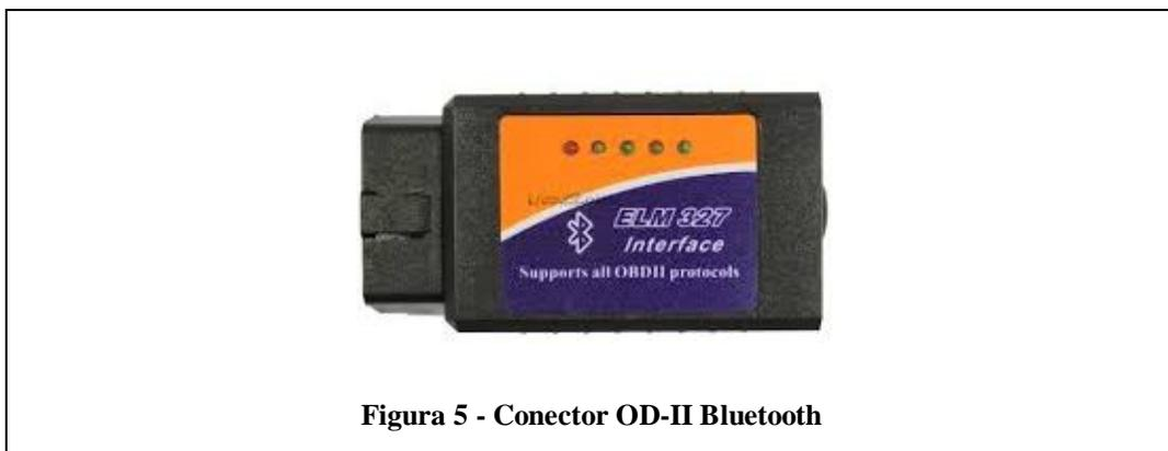
En concreto, este último conector, el ELM 327, ha sido el conector utilizado para el desarrollo y pruebas del presente Trabajo Fin de Grado.
