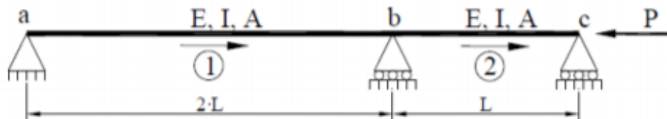
Ilustración 143: Estructura de pandeo de la práctica 5.1
