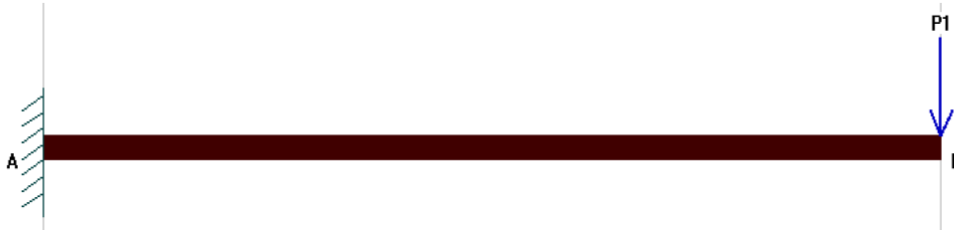
Ilustración 57: Estructura en forma de voladizo de la Práctica 3-O de ERM2
