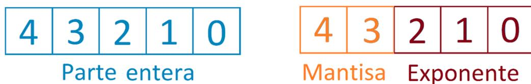
Ilustración 46: Ejemplo de representación de números en punto fijo y coma flotante.
