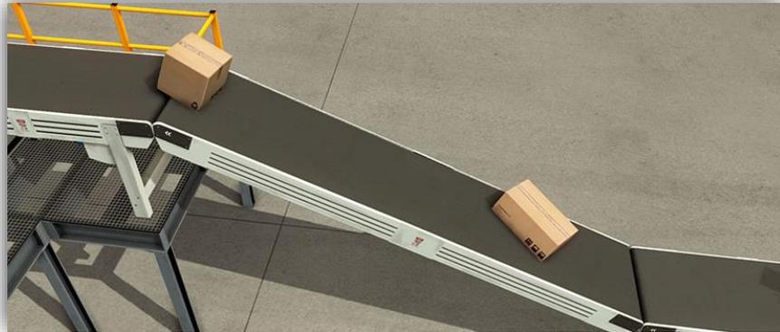
Imagen 23: Transportador de cinta inclinado.
