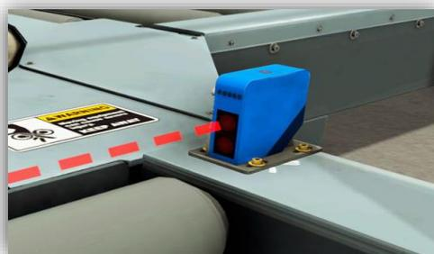
Imagen 38: Sensor fotoeléctrico.
