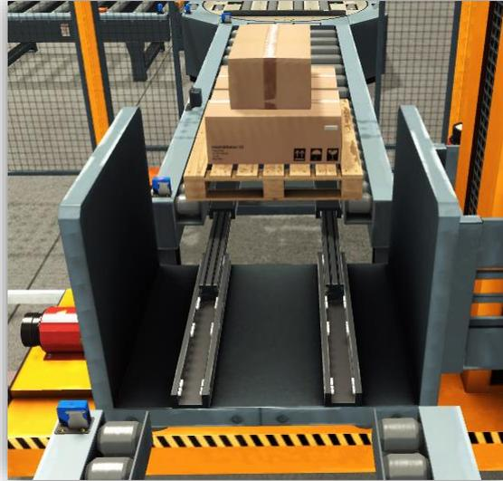
*Imagen 82: Horquillas extendidas recogiendo carga*
