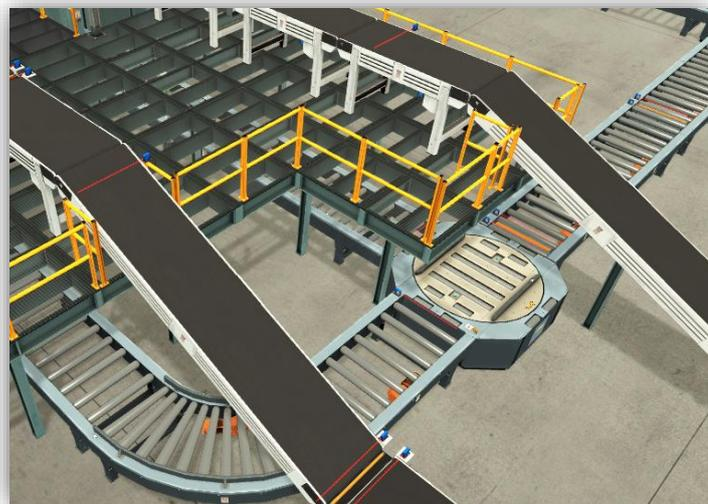
Imagen 19: Prolongación del nivel superior de la manutención ligera para evitar colisión con la mesa de giro.
