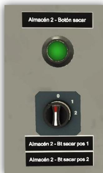
*Imagen 86: Controles extracción pallets almacén.*
