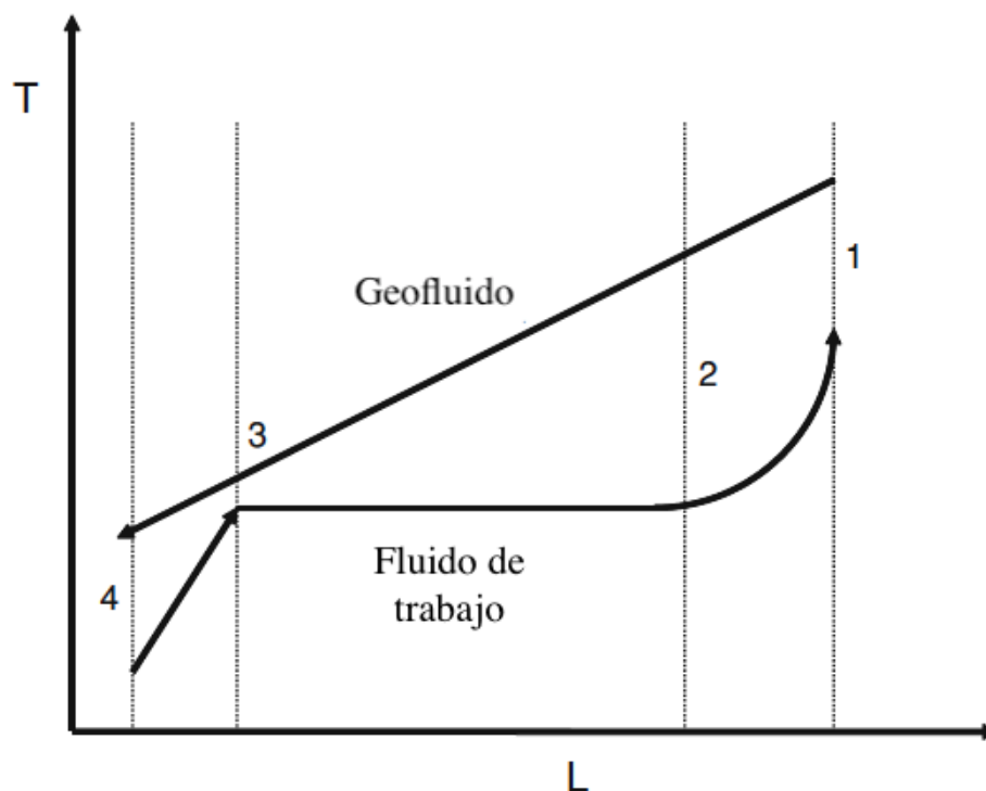
Figura 17. Diagrama Longitud (L)-Temperatura (T) del intercambiador de calor principal. Adaptado de [27].
