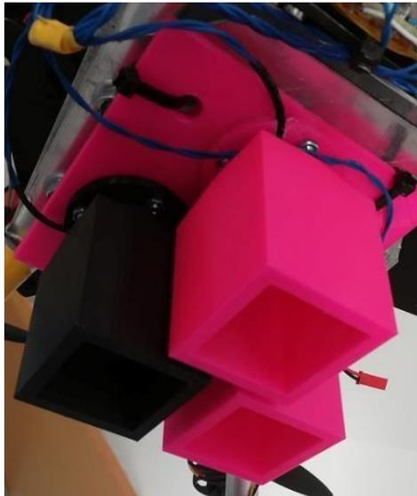
*Figure 18 – Système de largage intégré sur le drone*
