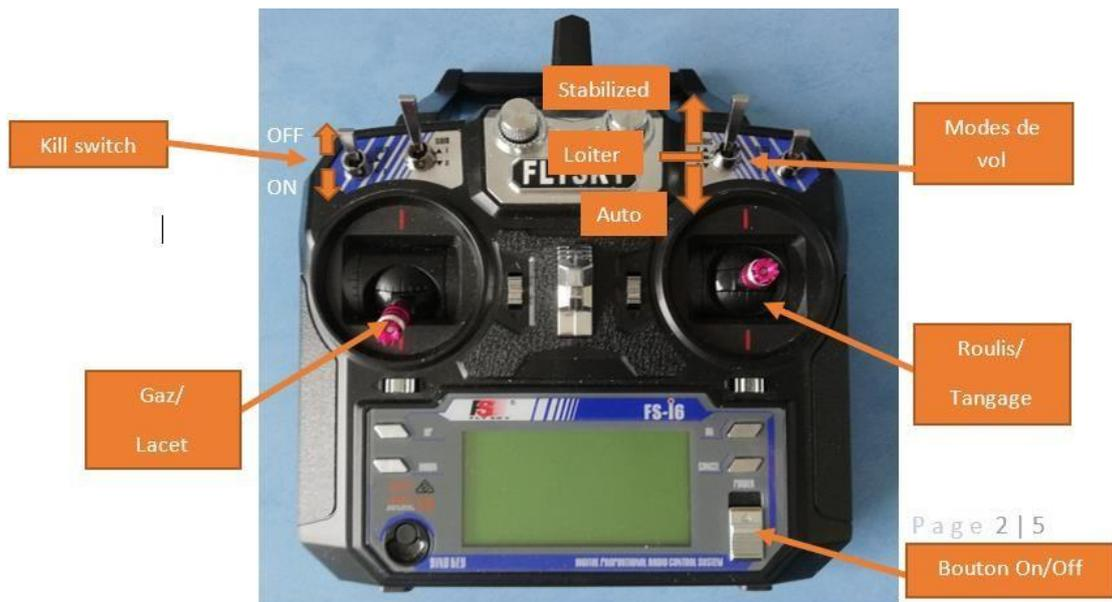
Pour armer le drone, une fois la mise en marche réussi, il suffit de maintenir la commande de lacet à droite pendant 3secondes (gaz à 0). Le drone devrait émettre un beep long, à la fin du beep, le drone est armé, on peut avoir la confirmation sur Mission Planner.
