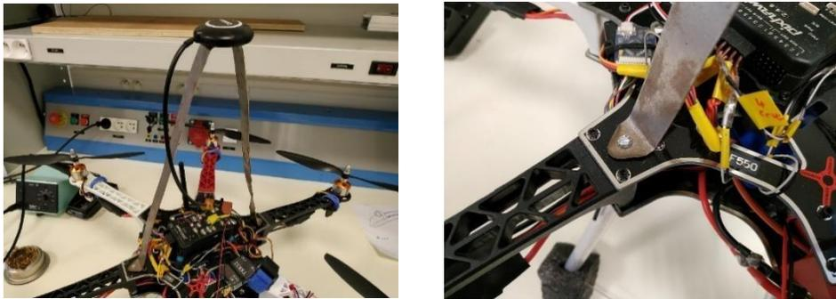
Figure 7 – Pont du GPS et fixation du pont
