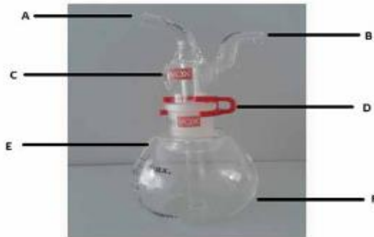
Figura 3. Doctor Vox recuperada de Denizoglu, 2018. A. Tubo de entrada, b. Cuello de cisne o tubo de salida, c. cámara de relajación, d. clips de bloqueo, e. cubierta de círculo, f. contenedor. Fuente(s): (Aquiahuatl, 2018)
