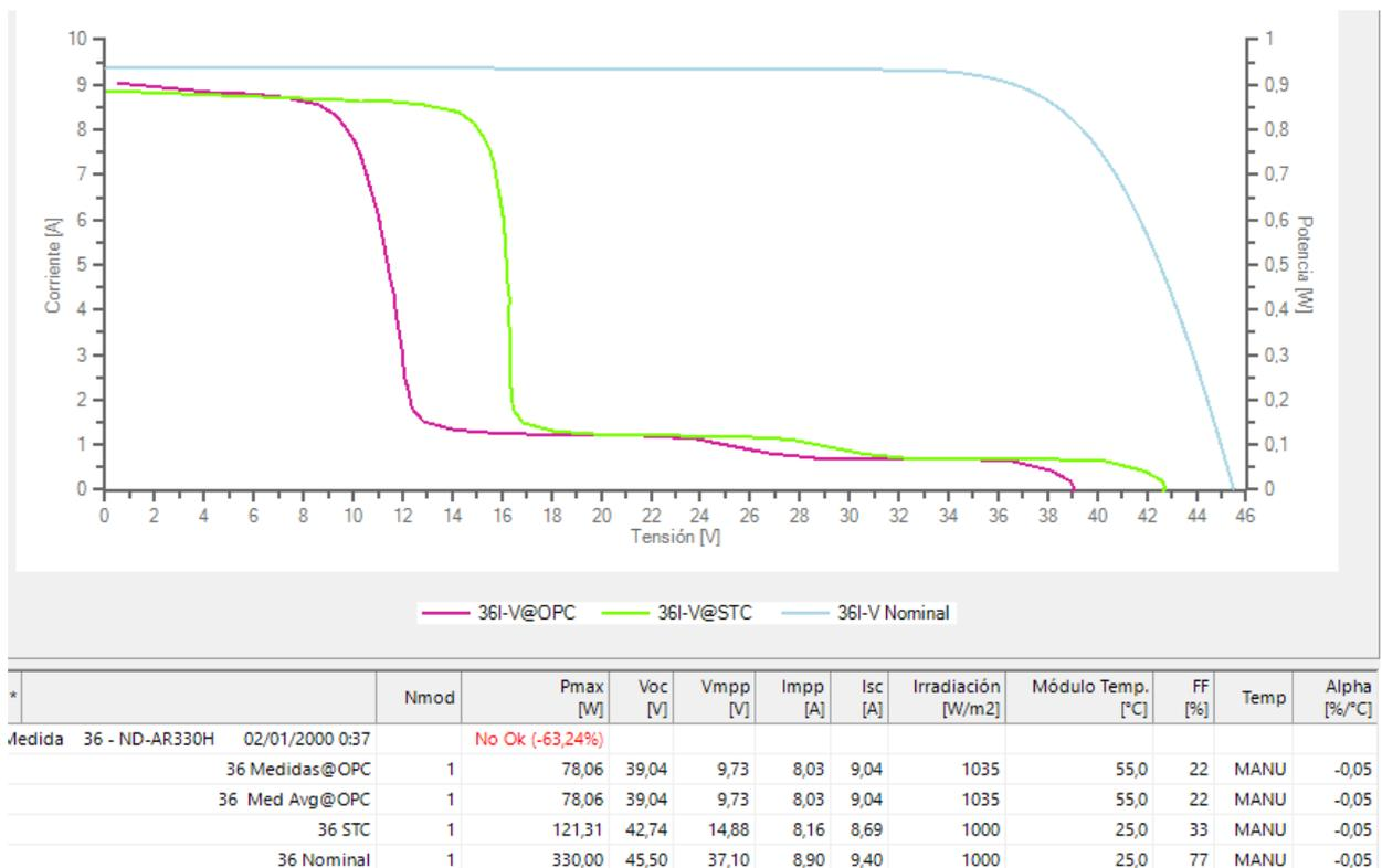
Ilustración 44. Curva I-V del módulo 8 provocando el efecto de una sombra (arriba). Tabla de datos numéricos del módulo 8 provocando el efecto de una sombra (abajo).
