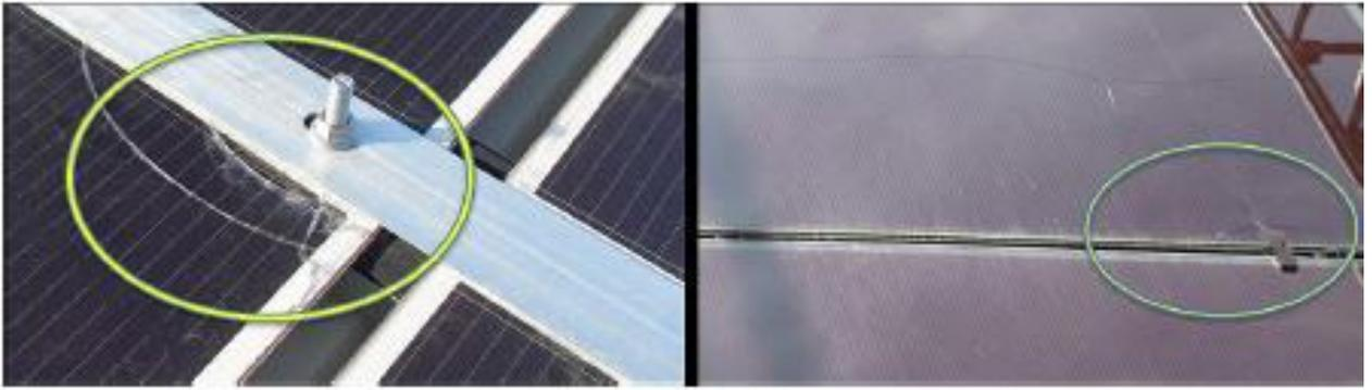
*Ilustración 11. Rotura de cristal debida a las sujeciones del módulo.*
