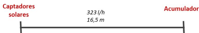
Imagen 17: Esquema de la red de solar para el punto máximo de trabajo.
