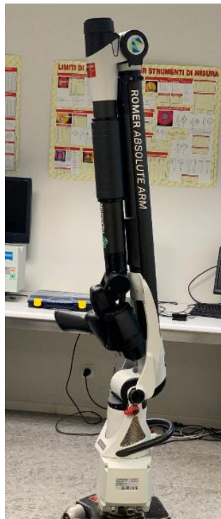
Figura 29: Brazo robótico modelo RA-7525 SI Romer Absolute Arm de la marca Hexagon.
