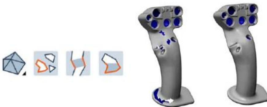
Figura 39: Completado de pequeñas zonas incompletas o mal realizadas.
