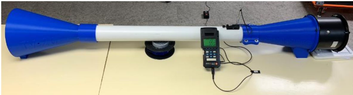
Figura 69: Prueba del túnel de viento con el motor monofásico de 220/230 VAC.
