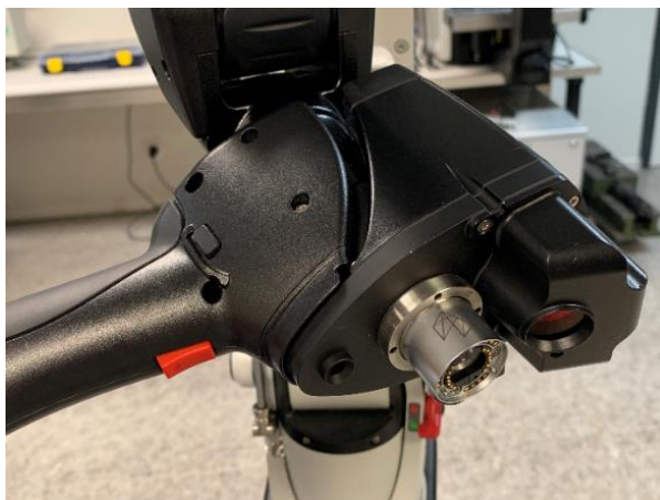
Figura 30: Láser de línea con un escáner modelo RS4.
