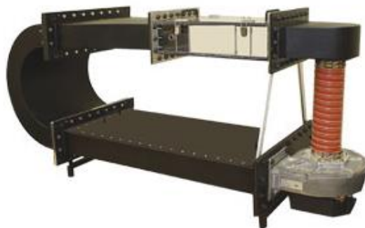
Figura 3: Túnel de viento cerrado. [5]
