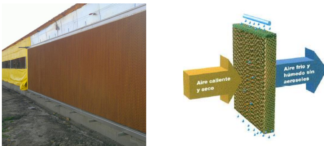
Figuras 16 y 17. Panel evaporativo de celulosa (izqda.) y esquema de funcionamiento (drcha.).
