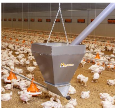
Figuras 4 y 5. Tolva de recepción de pienso sobre línea de comederos (izqda.) y unidad de control con unidad motriz de accionamiento de línea de distribución (drcha.).
