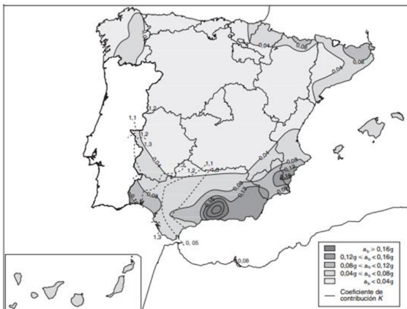
Figura 11. Mapa sísmico de la norma sismorresistente NCSE-02.
