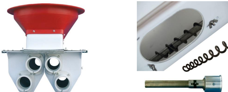
Figuras 3 y 4. Cajetín o unidad de carga bajo silo para distribución (izqda.) y espiral flexible con tubo de restricción instalado a comienzo de línea (drcha.).
