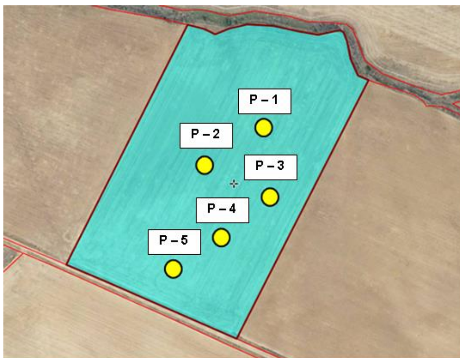
Figura 4. Ubicación aproximada de los cinco ensayos de penetración dinámica (en amarillo) realizados en la parcela objeto del estudio.
