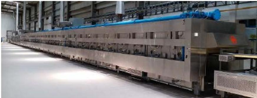
**Figura 8. Horno de cocción a calefacción mixta.**
