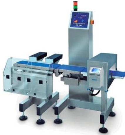
Figura 11. Detector de metales con control de peso.
