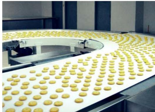
**Figura 9. Cinta transportadora de enfriamiento.**
