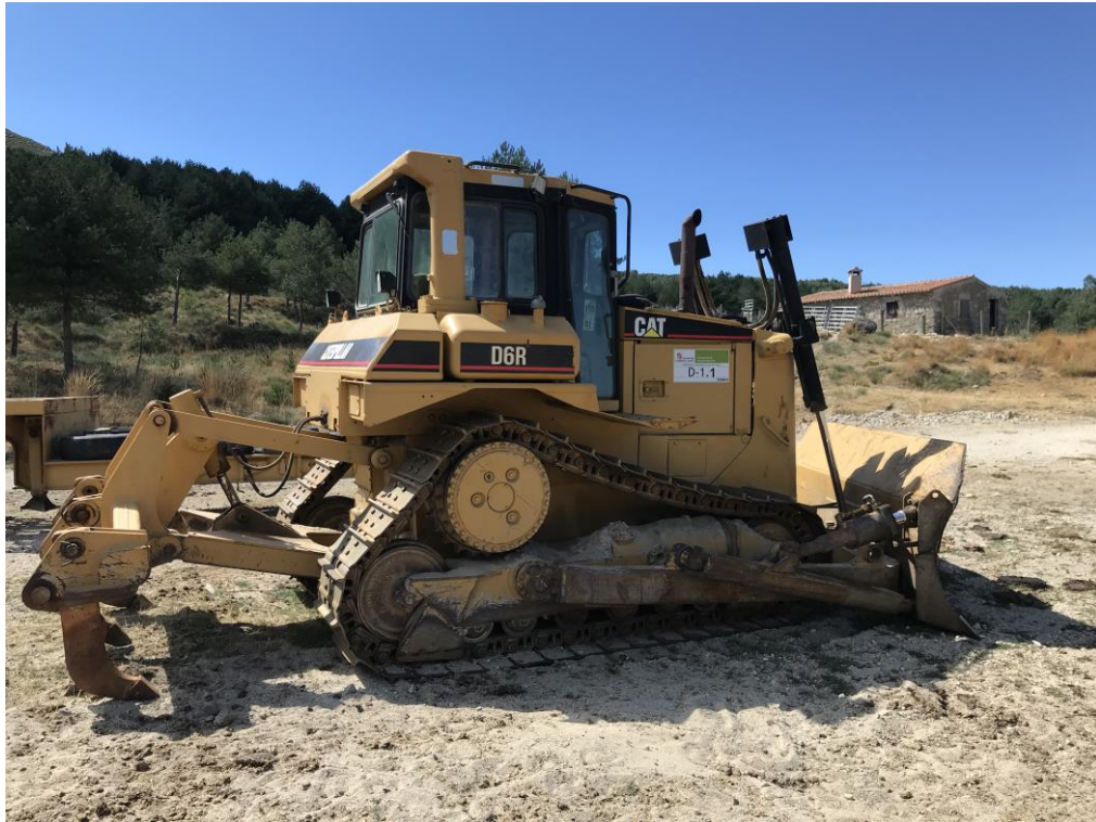
Figura 28. Tractor de cadenas con pala angledozer, modelo Caterpillar D6R con indicativo Delta 1.1.. (Fuente: Elaboración propia).
