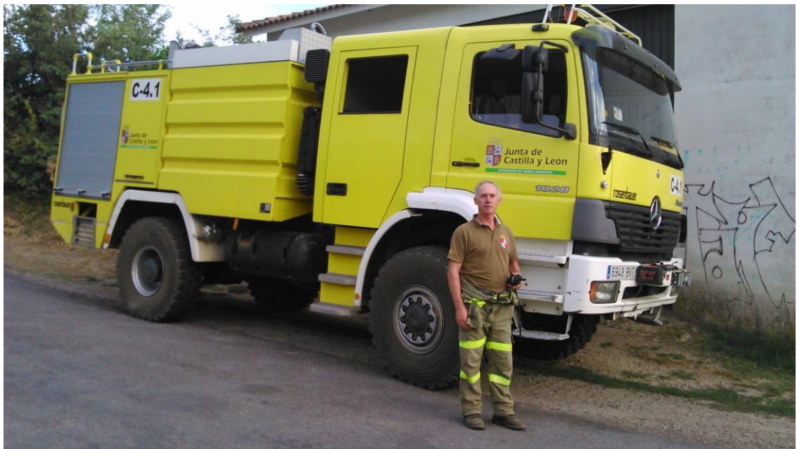
Figura 26. Autobomba con indicativo C-4.1 ubicado en el término de Poyales del Hoyo con una capacidad de 5000 litros. Mercedes Atego 1828AK. (Fuente: Elaboración propia).
