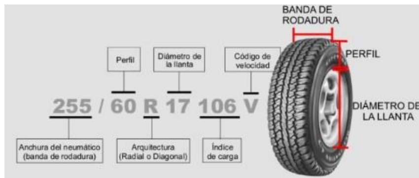
Figura 14: designación tipo de neumático [26]
