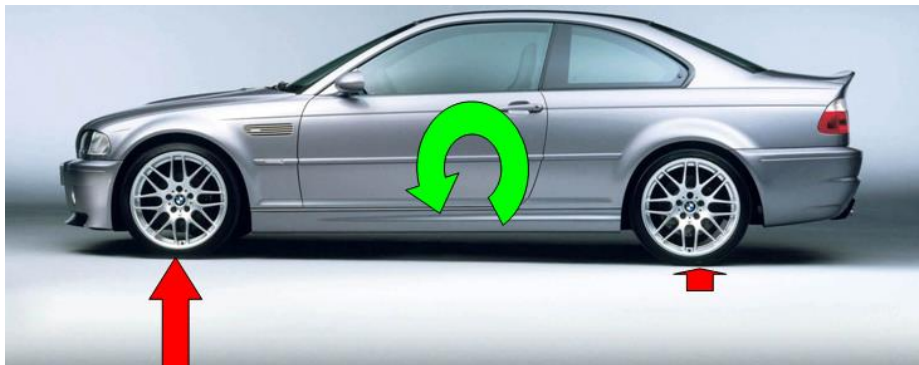
Figura 19: representación de la transferencia de carga durante la frenada [31]
