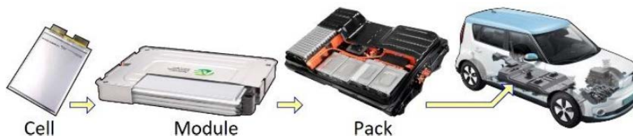
Figura 12. Empaquetamiento de la batería de un vehículo eléctrico [Vidyanandan, 2019]
