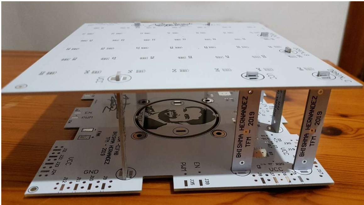
Figura 16 – Montaje final del sistema de iluminación IRIS
