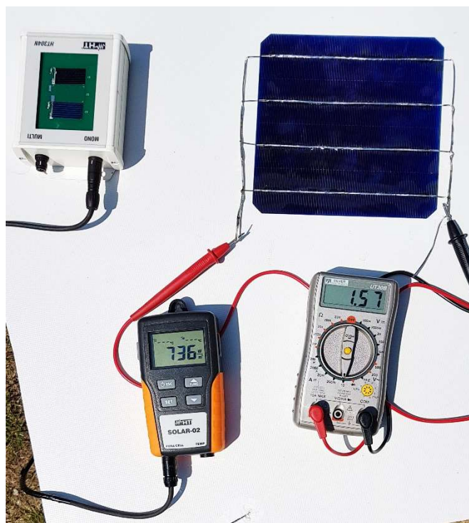
Figura 27 – Irradiancia y corriente I_{sc} medida bajo el SOL en condiciones reales
