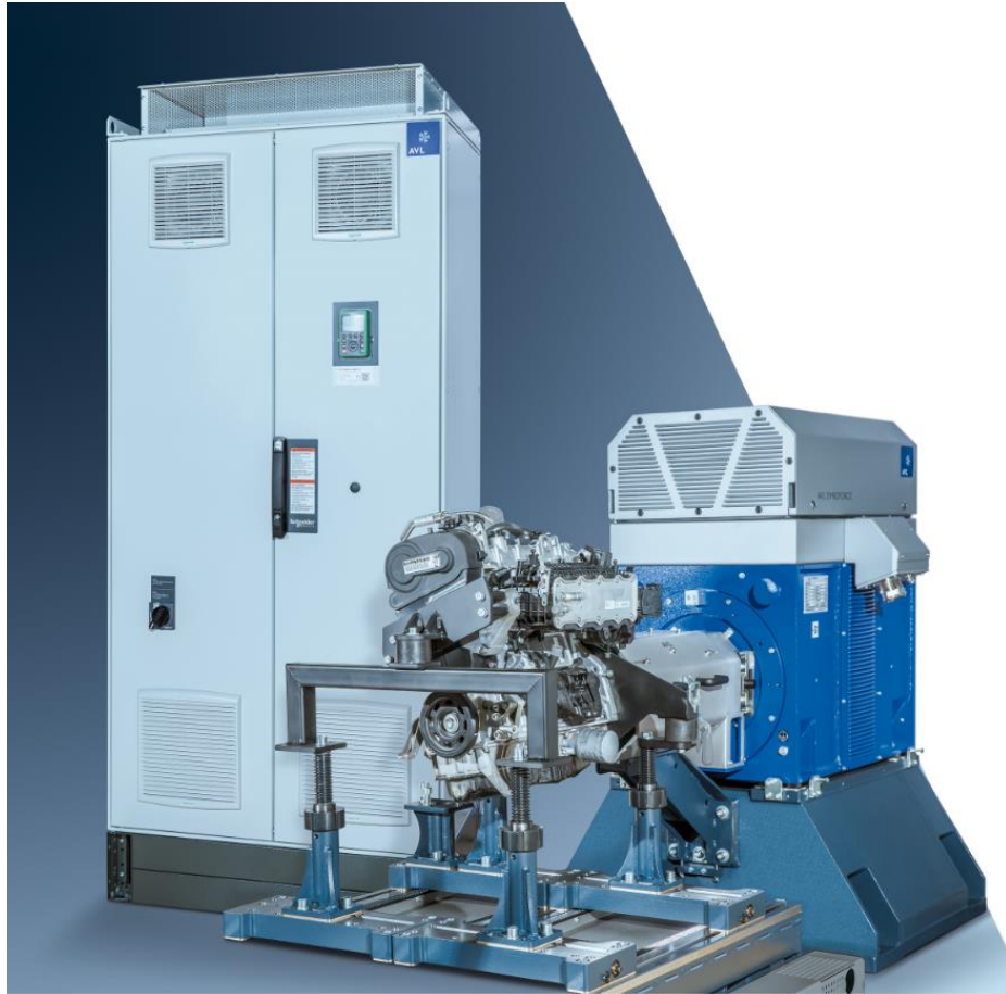
Fig.3.3 Ejemplo de dinamómetro activo y su armario eléctrico
