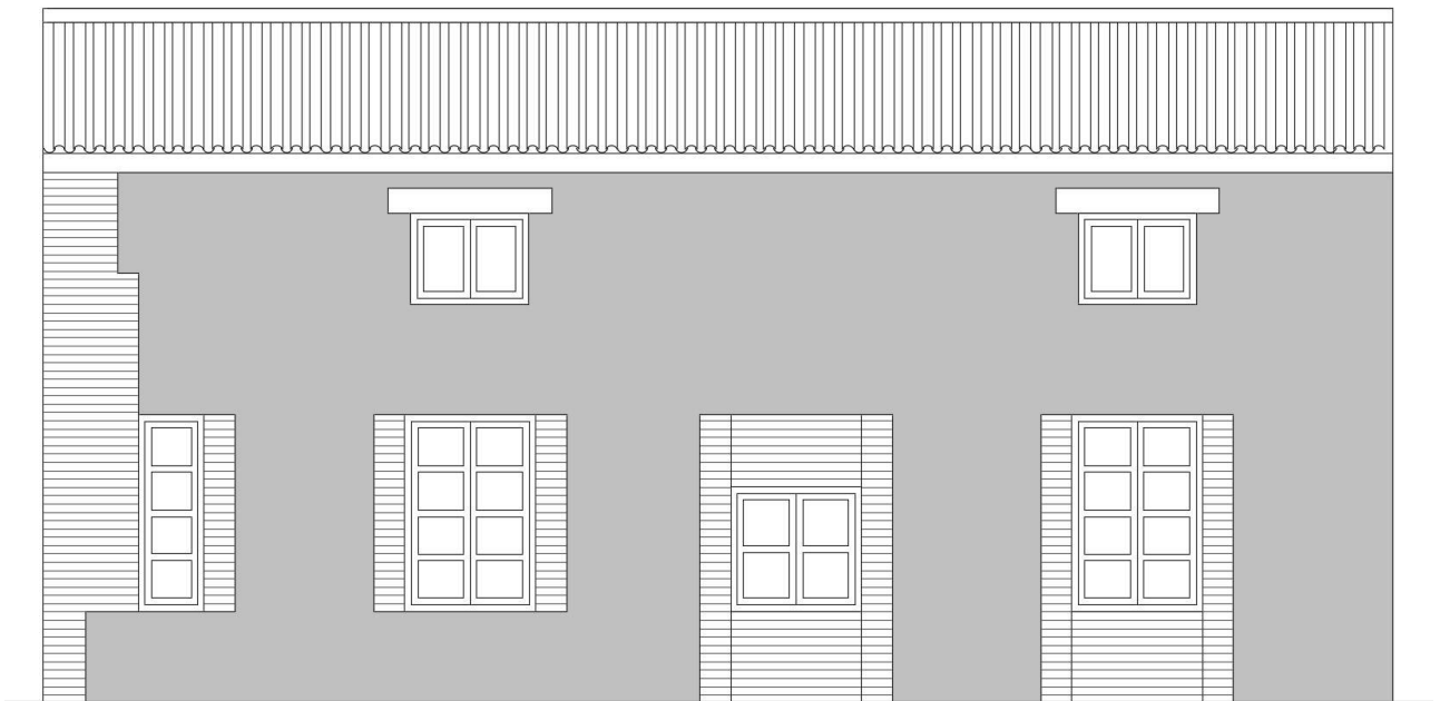
Figura 36 Fachada posterior vivienda unifamiliar
