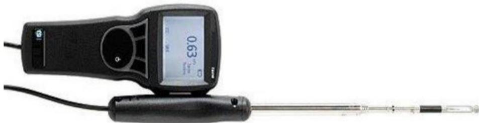
Figura 31. Anemómetro de hilo caliente para la realización de la práctica.
