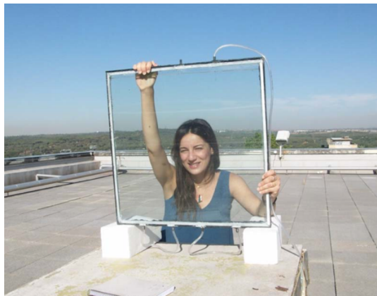
Ilustración 50. Demostración de la transparencia total de los vidrios con cámara de agua. Fuente: (Lauret & Ovando, 2016).
