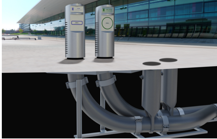
Ilustración 71. Trampillas y conductos en la primera fase de recogida. Fuente: (Logiwaste, 2020).
